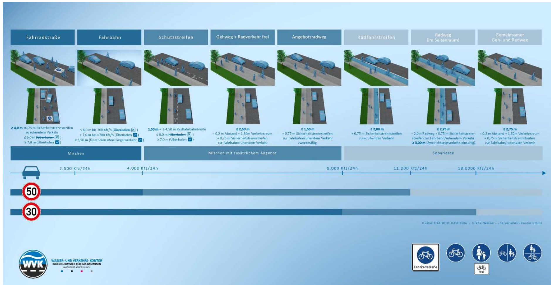
Abbildung 2.3: Formen der Radverkehrsführung nach ERA 10 [3], RAST 06 [4]
